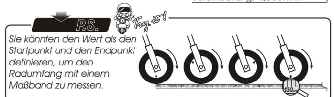
● Beispiel: Die Einstellung des Reifenumfangs kann von 1.000 mm bis 1.300 mm geändert werden.
