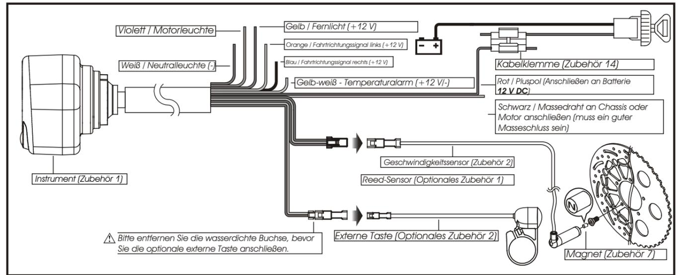
Bitte entfernen Sie die wasserdichte Buchse, bevor Sie die optionale externe Taste anschließen.
